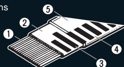
Les rubans Symron en fibre de verre Tajima n'ont aucune conductivité électrique et possèdent un revêtement de la surface en PVC transparent. Ce revêtement spécial rend les rubans de Tajima 100 fois plus résistants à l'usure que des rubans en fibre de verre sans revêtement.
