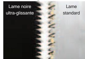
\*Les lames noires Black Power Glide et une lame standard après 100 coupes de branches d'une épaisseur de 40 mm
